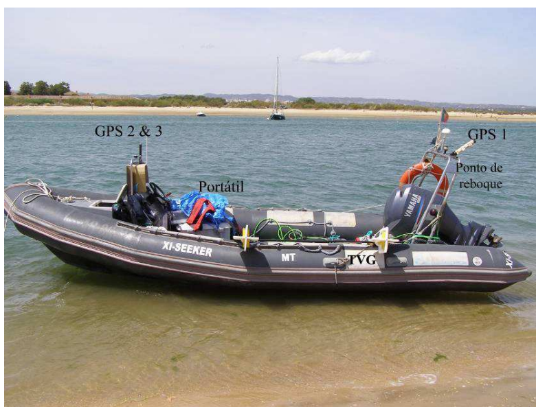
Fotografia 1 – Embarcação configurada para aquisição de dados por gradiometria. (Foto: Mikhail Tchernychev)
